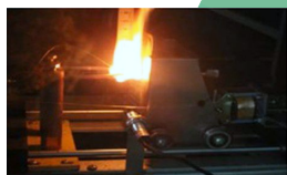
图 12 接线盒支撑带电体部分开始燃烧
