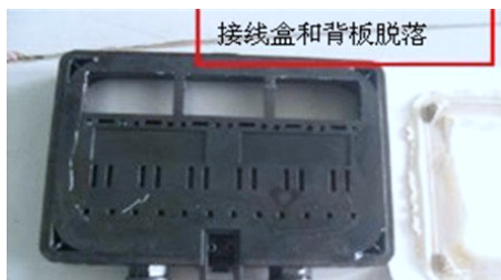
图 10 湿热试验后接线盒与背板脱落
