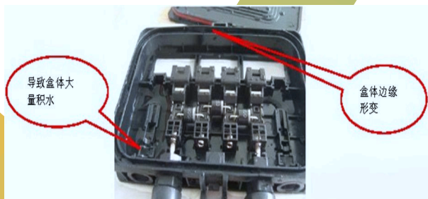
图 6 老化试验后盒盖变形影响密封导致积水
