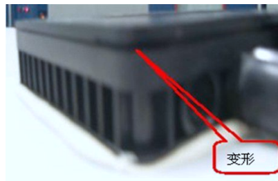
图 9 湿热试验后接线盒变形
