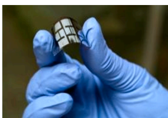
微观褶皱提高太阳能电池的输出功率和耐久性。
