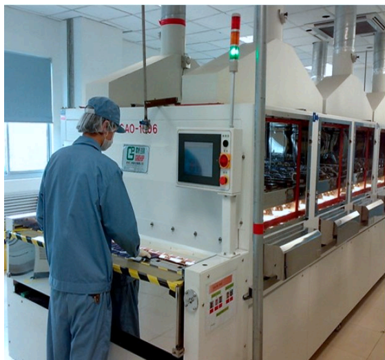
尚德公司对太阳能电池进行预衰减处理
