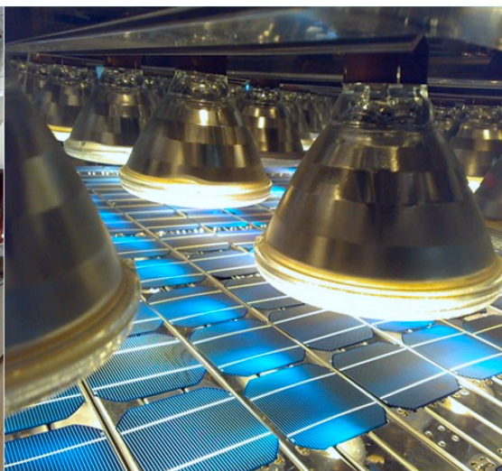
尚德公司对太阳能电池进行预衰减处理
